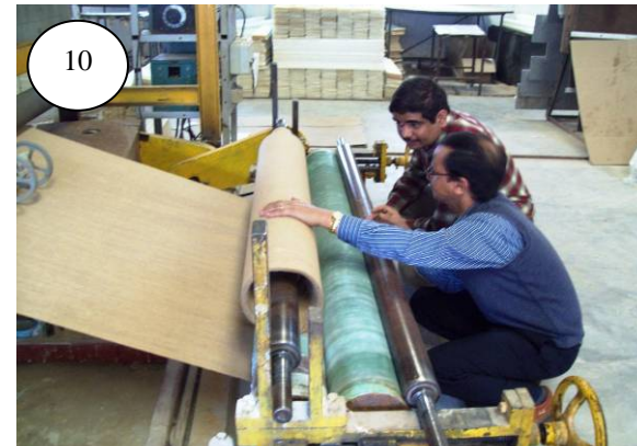
FINAL NR COATED JUTE FABRIC
