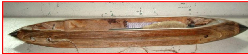
Fig 20-a : Top Shed Shuttle
